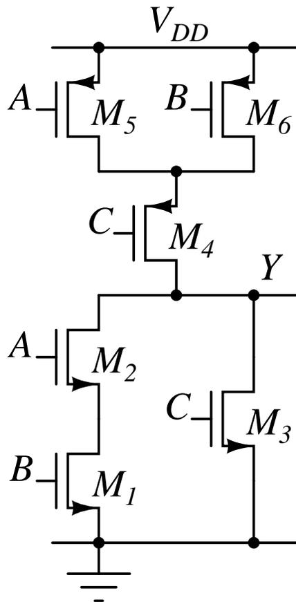
Come prima cosa è bene identificare il pull - up ed il pull - down del circuito; il pull - up è rappresentato dai transistori PMOS, mentre il pull - down è rappresentato dai transistori NMOS.
